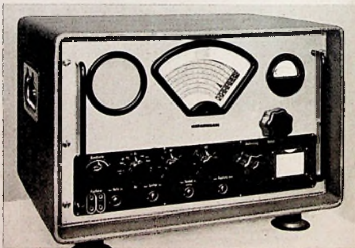
Allwellenempfänger „E 103 Aw/4“ für Schiffs- und Küstenstationen; Universalempfänger für Presse, Polizei und Wetterdienst sowie für beliebige andere Funkdienste (Telefunken)
